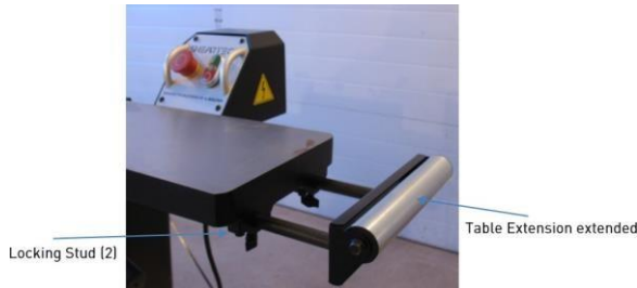
РИСУНОК 22: РАСШИРЕНИЕ СТОЛА ПОДАЧИ
