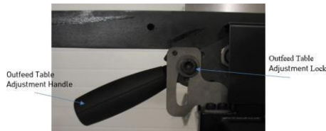
Рисунок 24: РЕГУЛИРОВКА СТОЛА ПОДАЧИ
