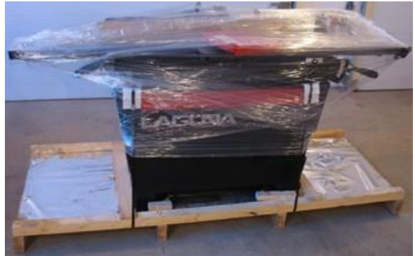
Рис.4: Снятие внешнего ящика
