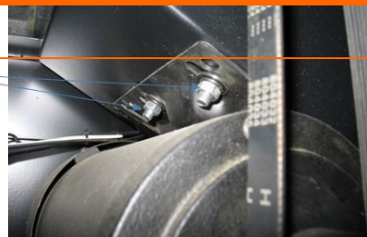
Рис. 25: ДВА ИЗ ЧЕТЫРЕХ КРЕПЕЖНЫХ БОЛТОВ ДВИГАТЕЛЯ
