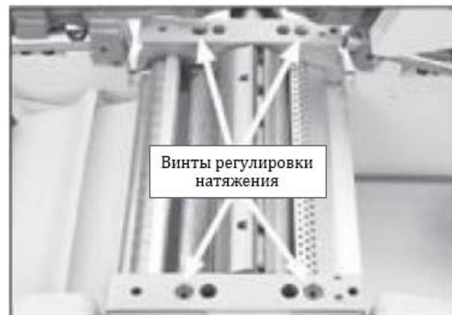
*Рис. 57. Винты регулировки натяжения пружины*
