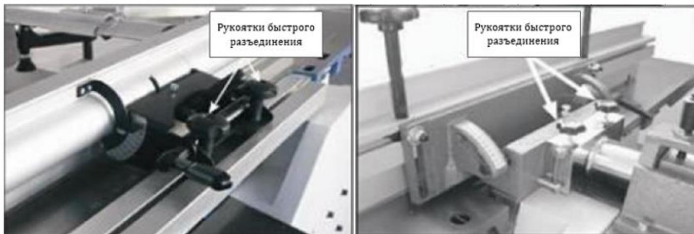
**Рис. 20. Снятие параллельного упора**
