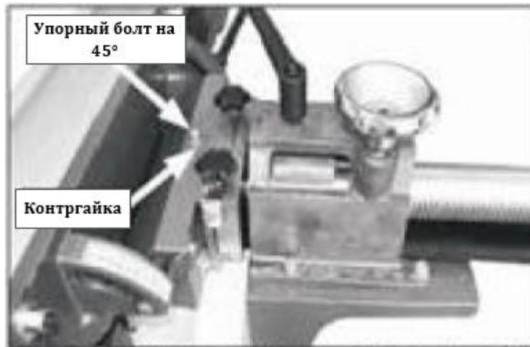
*Рис. 50. Регулировка параллельного упора под 45° наружу*
