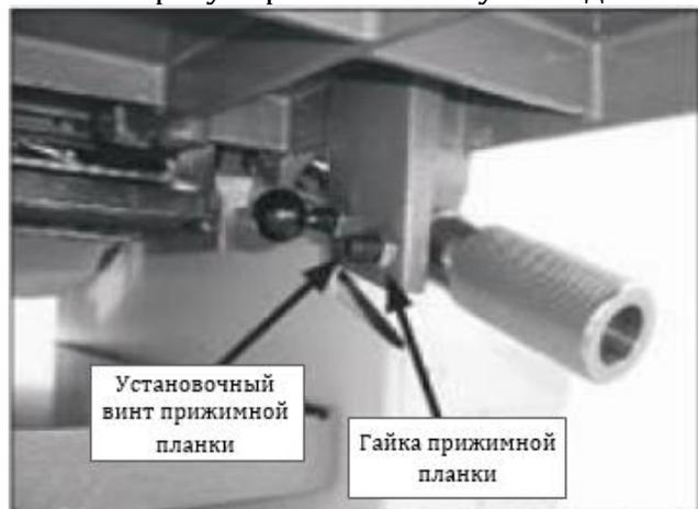
**Рис. 52. Регулировка прижимной планки подводного стола**
