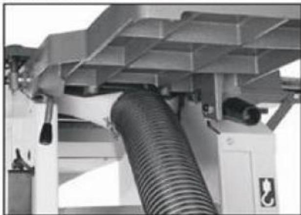
**Рис. 12. Рукав аспирации опилок, закреплённый на фуговальном станке**
