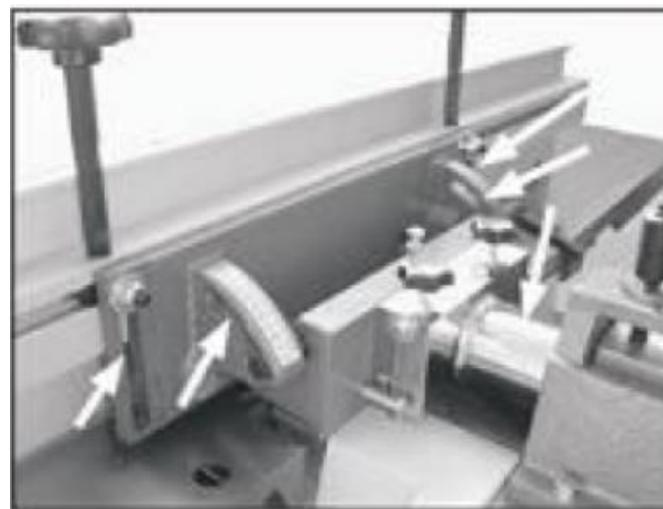
*Рис. 30. Точки смазки параллельного упора*
