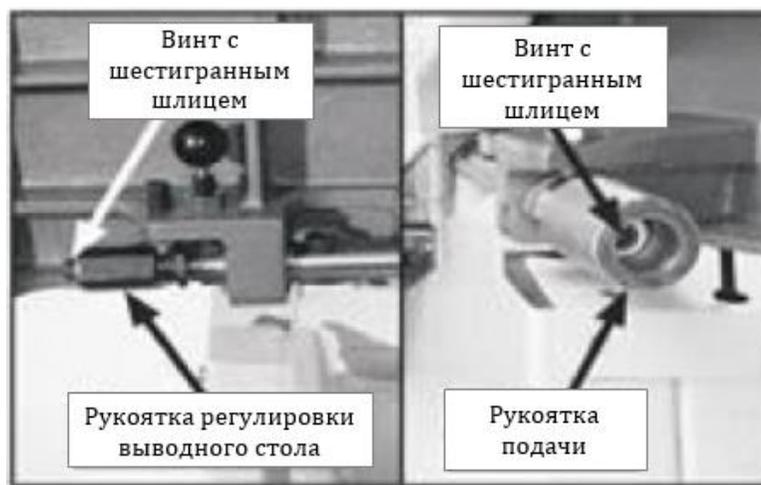
Рис. 16. Расположение органов регулирования столов
