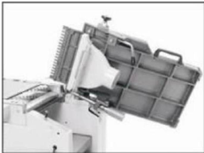
**Рис. 22. Подводной стол в верхнем положении**
