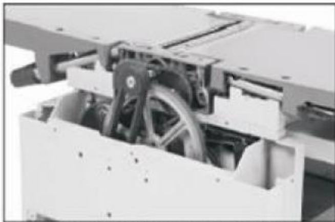
**Рис. 46. Снятые параллельный упор и крышка клиноремённой передачи**
