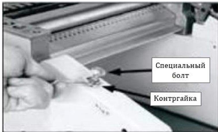
*Рис. 51. Болт рычага фиксации стола*
