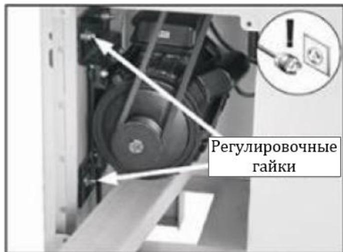
**Рис. 26. Снятие натяжения клиновых ремней**
