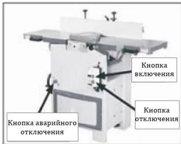
Рис. 15. Расположение кнопок включения-отключения
