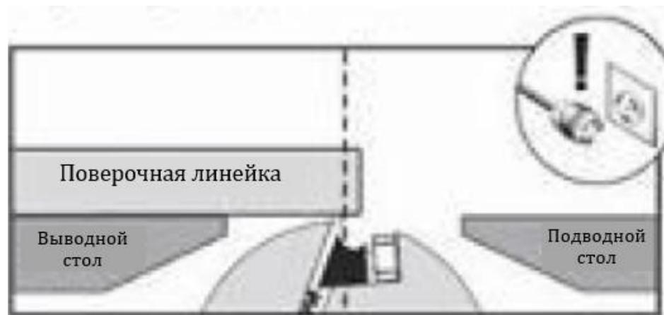
Рис. 9. Использование поверочной линейки для выравнивания выводного стола
