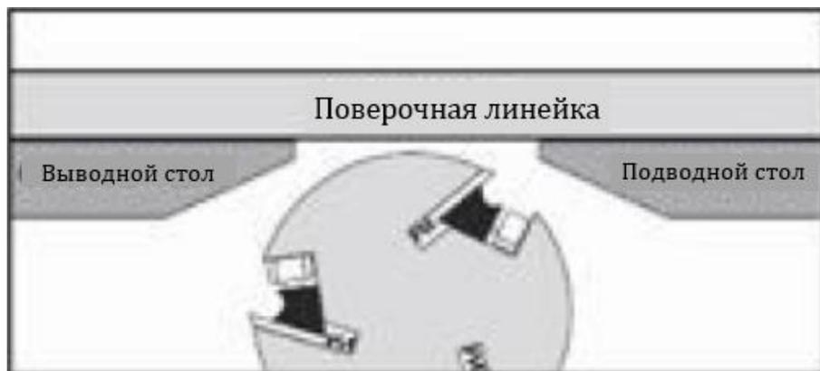
**Рис. 34. Установленные вровень подводной и выводной столы**
