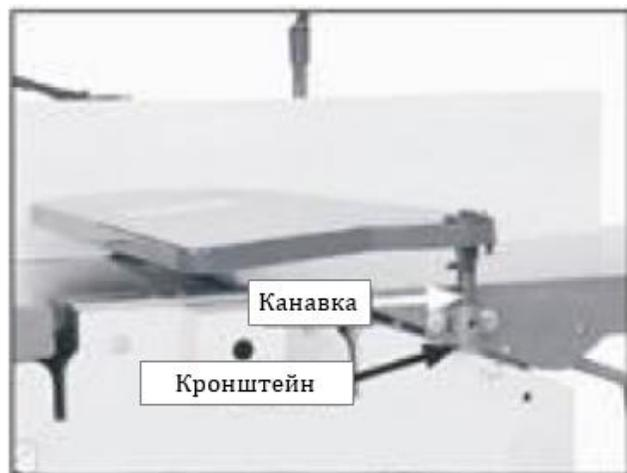
Рис. 10. Установка ограждения режущего вала
