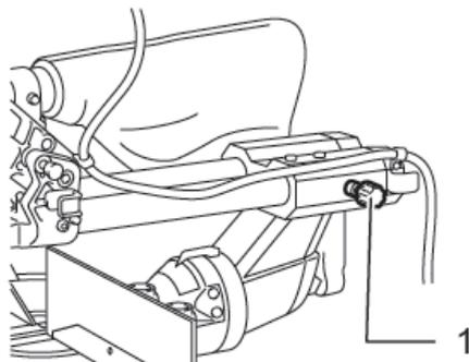
**РЕГУЛИРОВКА СДВИЖНЫХ ЩЕЧЕК БОКОВОГО УПОРА (Рис. N,O) (сдвижной – дополнительный боковой упор)**
