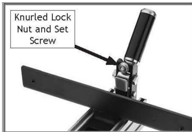
Рисунок 117. Установочный винт для регулировки давления прижима ручки ограждения.
