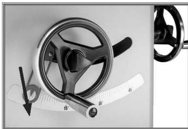
Рисунок 100. Расположение стрелки индикатора наклона.
