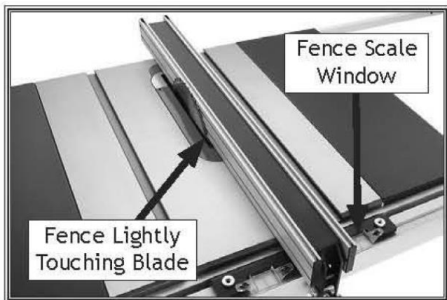
Рисунок 29. Калибровка шкалы параллельного упора.
