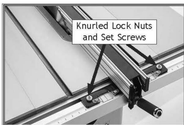
Рисунок 112. Расположение винтов регулировки наклона параллельного упора.
