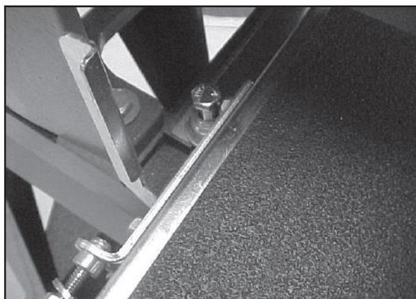
Рис. 17 Болты крепления встроенного конвейера.
