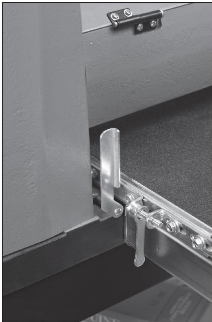
Рис. 9 Подвесной ключ 1 из 2, для отслеживания конвейера
