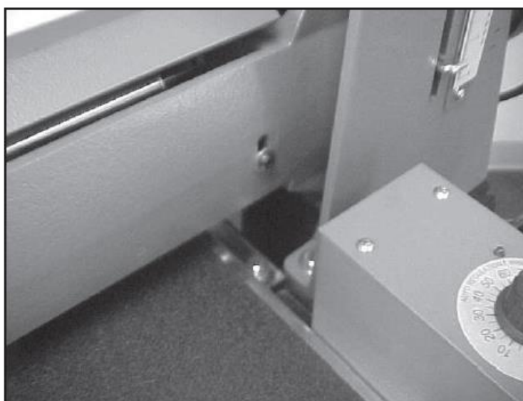
Рис. 11 Регулировка высоты и глубины натяжного ролика
