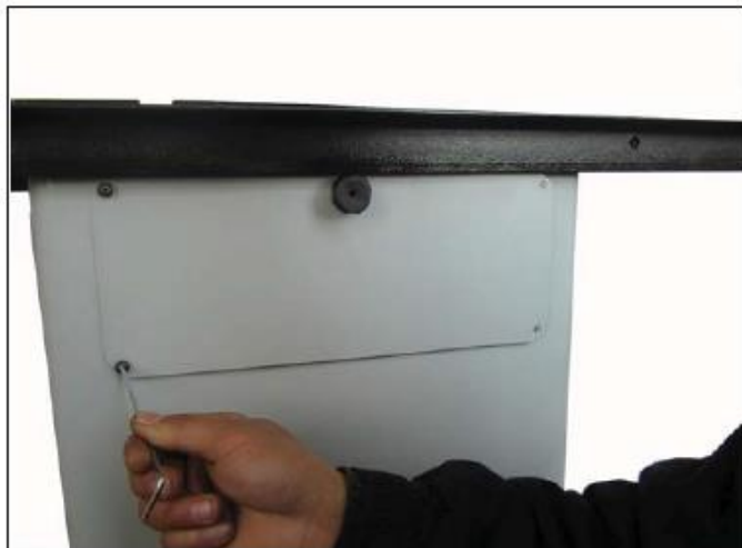
Рис. 33. Снять панель доступа к качающейся опоре
