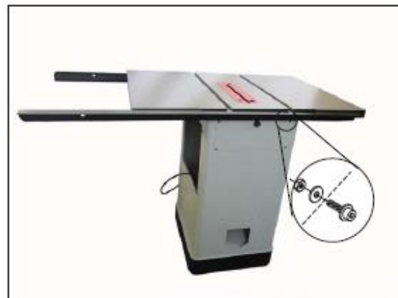
Рис. 10. Установленная на станке задняя направляющая
