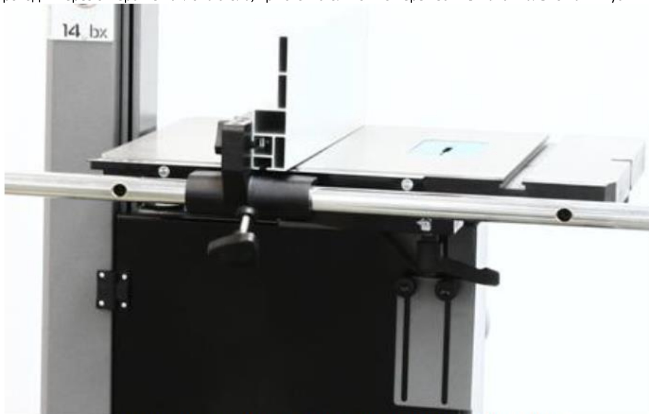
Стол, установленный на ленточнопильном станке
