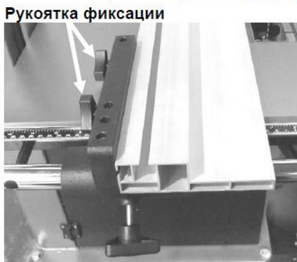
Параллельный упор, зафиксированный в нижнем положении
