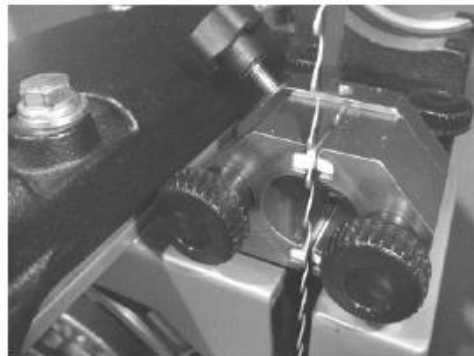
Боковые направляющие отрегулированы с керамическими колодками точно за впадинами
