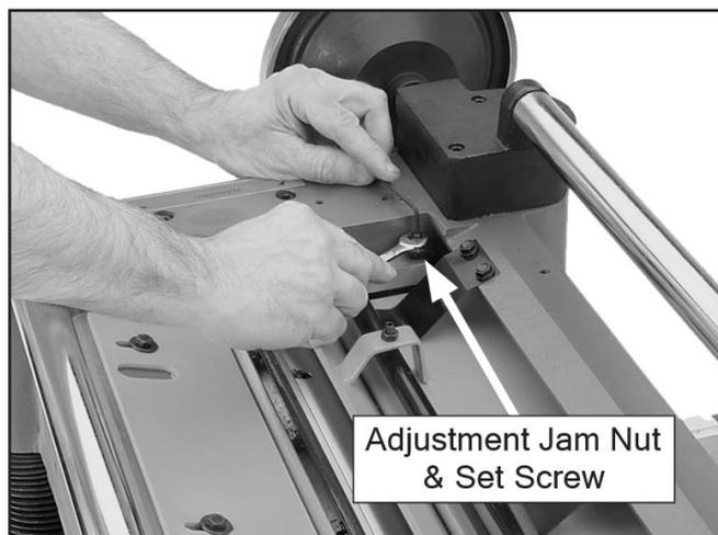
Рисунок 42. Пример регулировки высоты прижимной планки.
