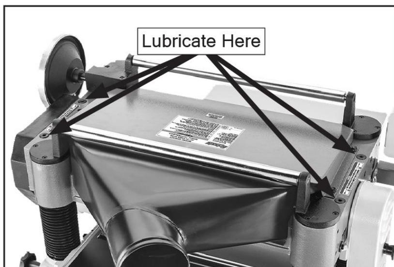
Рисунок 28. Места смазывания втулок подающих роликов.
