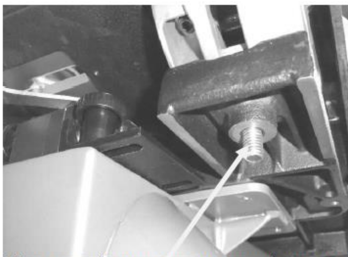
Шпилька фиксации качающейся опоры
