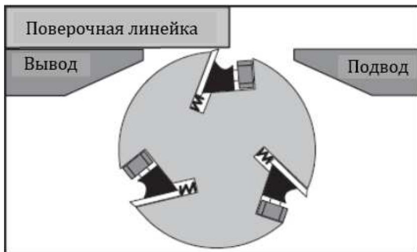
Рис. 22. Подводной стол, отрегулированный вровень с выводным столом и ножом в ВМТ
