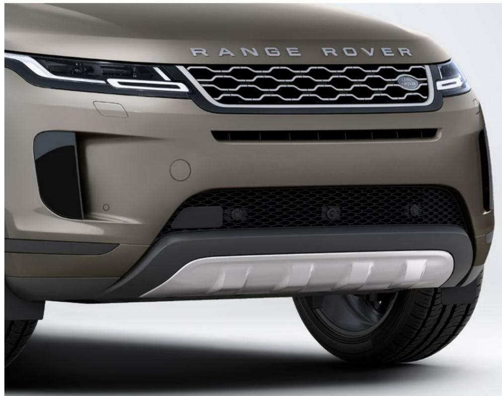
**Защита нижней части кузова – нержавеющая сталь, передняя и задняя**
