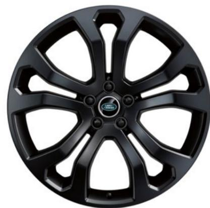
22-дюймовый легкосплавный диск Style 5014 с пятью сдвоенными спицами, кованный, полностью окрашенный, с отделкой Low Gloss Black
