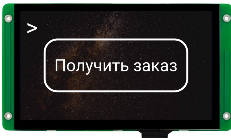
Лео4 И-7 - модуль сенсорного интерфейса размером 7".
