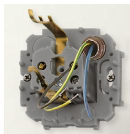
Снимите корпус изделия. На суппорте удалите заглушку с одного из 4-х кабельных вводов. Осуществите подключение проводки к контактам механизма.
