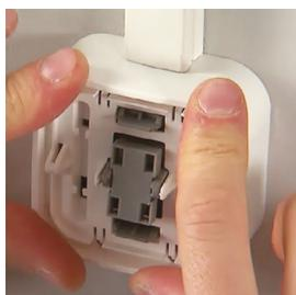
Вырежьте кабельный ввод в корпусе изделия по преднарезанному контуру необходимого сечения (см. таблицу сечений на стр. 28). Подключите провода к механизму, установите корпус и лицевую панель.
