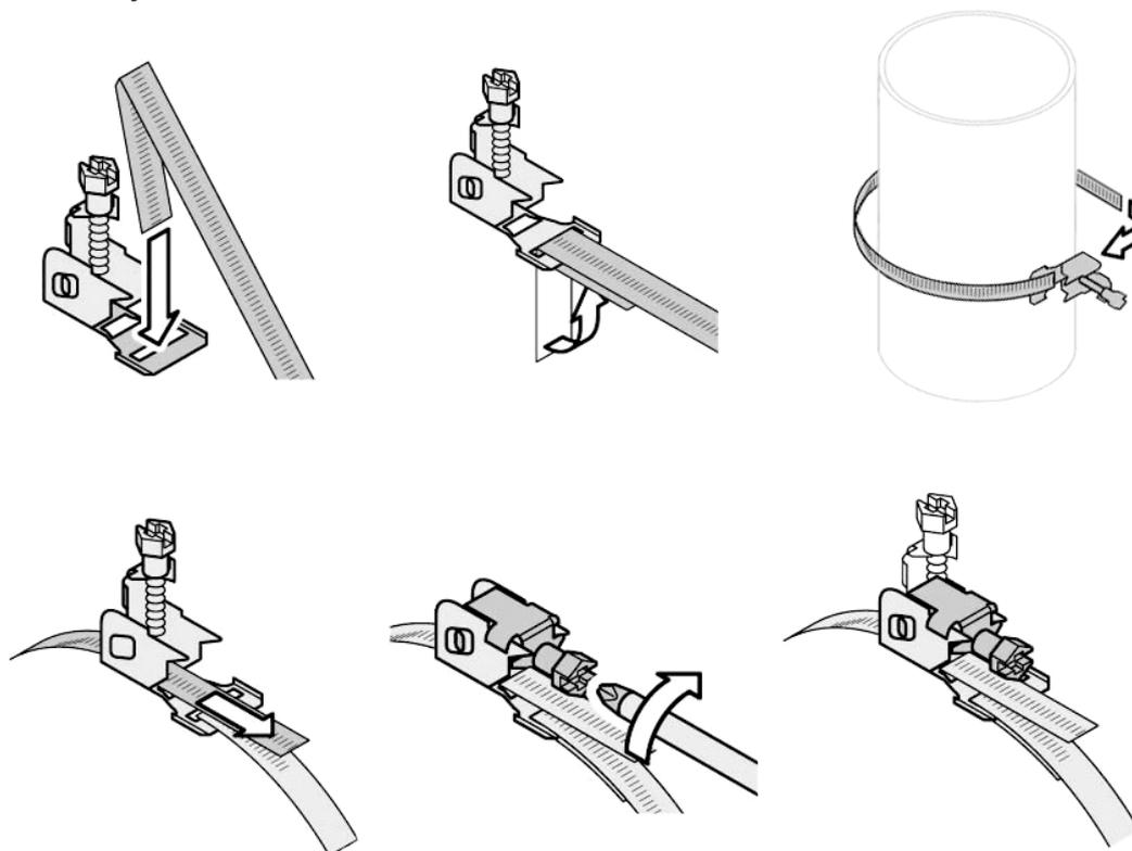
Рис. 3. Порядок работы с монтажной лентой
