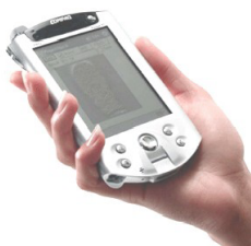
Рис. 2.6. Мобильный КПК HP IPAQR h5400 с FingerChip для биометрической аутентификации
