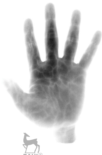
Рис. 1.5. Иллюстрация сканирования ладони по ее геометрии и рисунку вен
