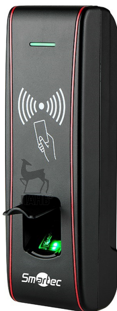
Рис. 2.3. Считыватель смарт-карт Smartec с аутентификацией по отпечатку пальца
