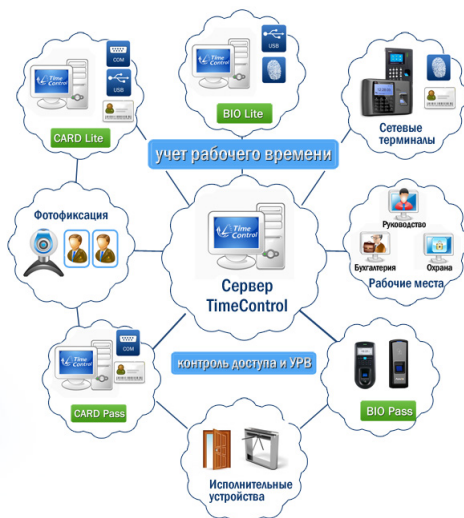
Рис. 1.1. Блок-схема элементов системы учета рабочего времени
