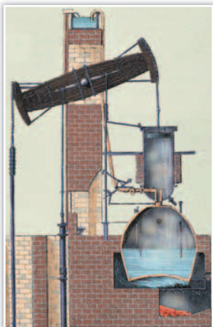
Паровой двигатель Ньюкомена. Схема
