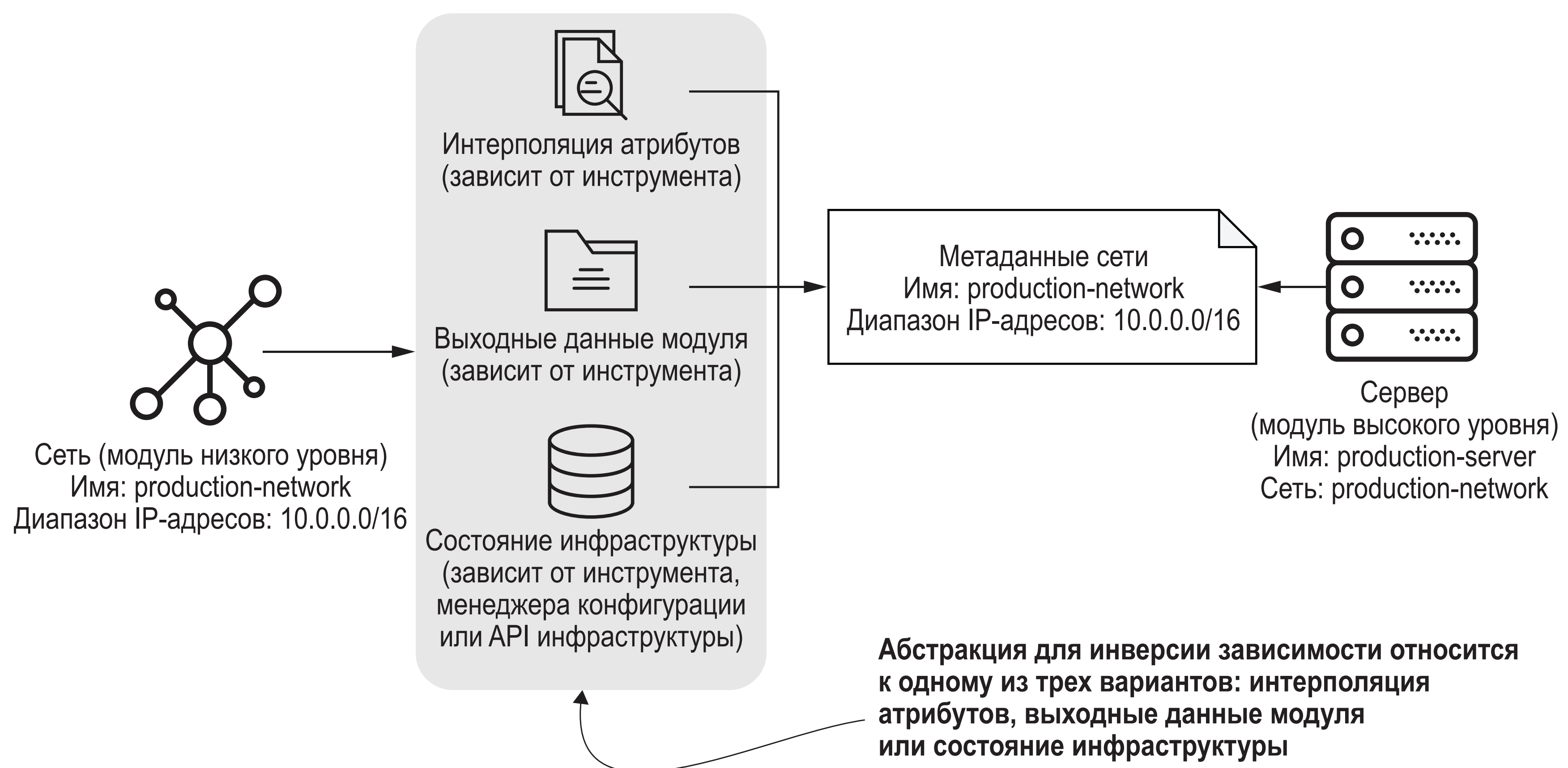
Рис. 4.5 В зависимости от инструмента и зависимостей абстракции для инверсии зависимостей могут использовать интерполяцию атрибутов, выходные данные модуля или состояние инфраструктуры
