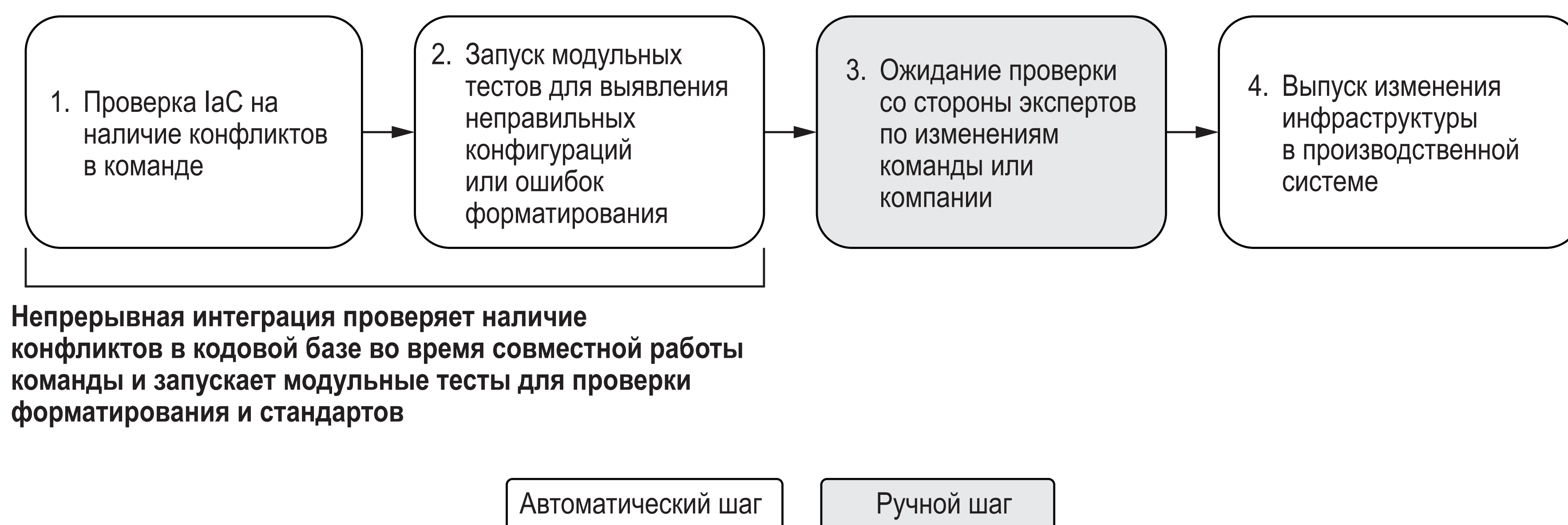
Рис. 7.3 Фреймворк CI в конвейере поставки выполняет автоматизированные модульные тесты перед ожиданием ручного утверждения запуска в производство
