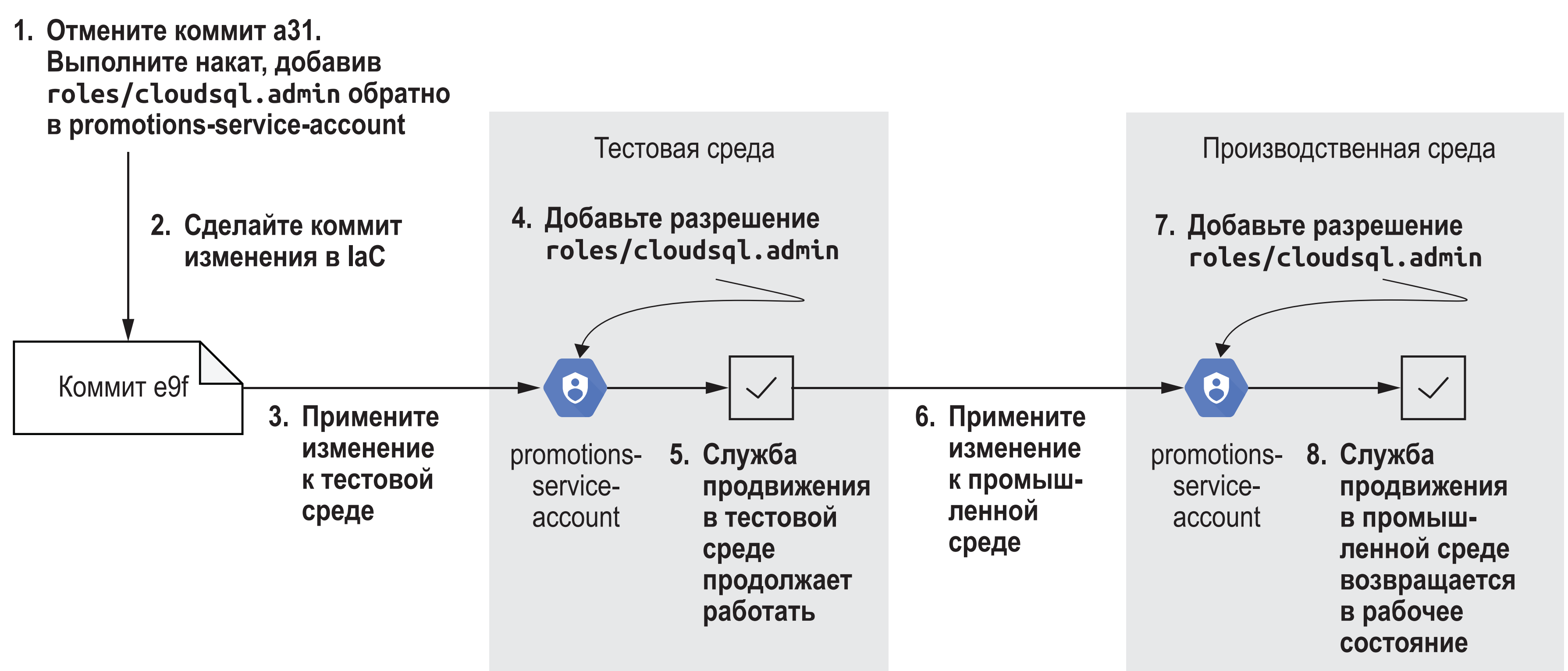
Рис. 11.2 Добавление роли администратора базы данных для службы продвижения, чтобы выполнить накат системы до рабочего состояния
