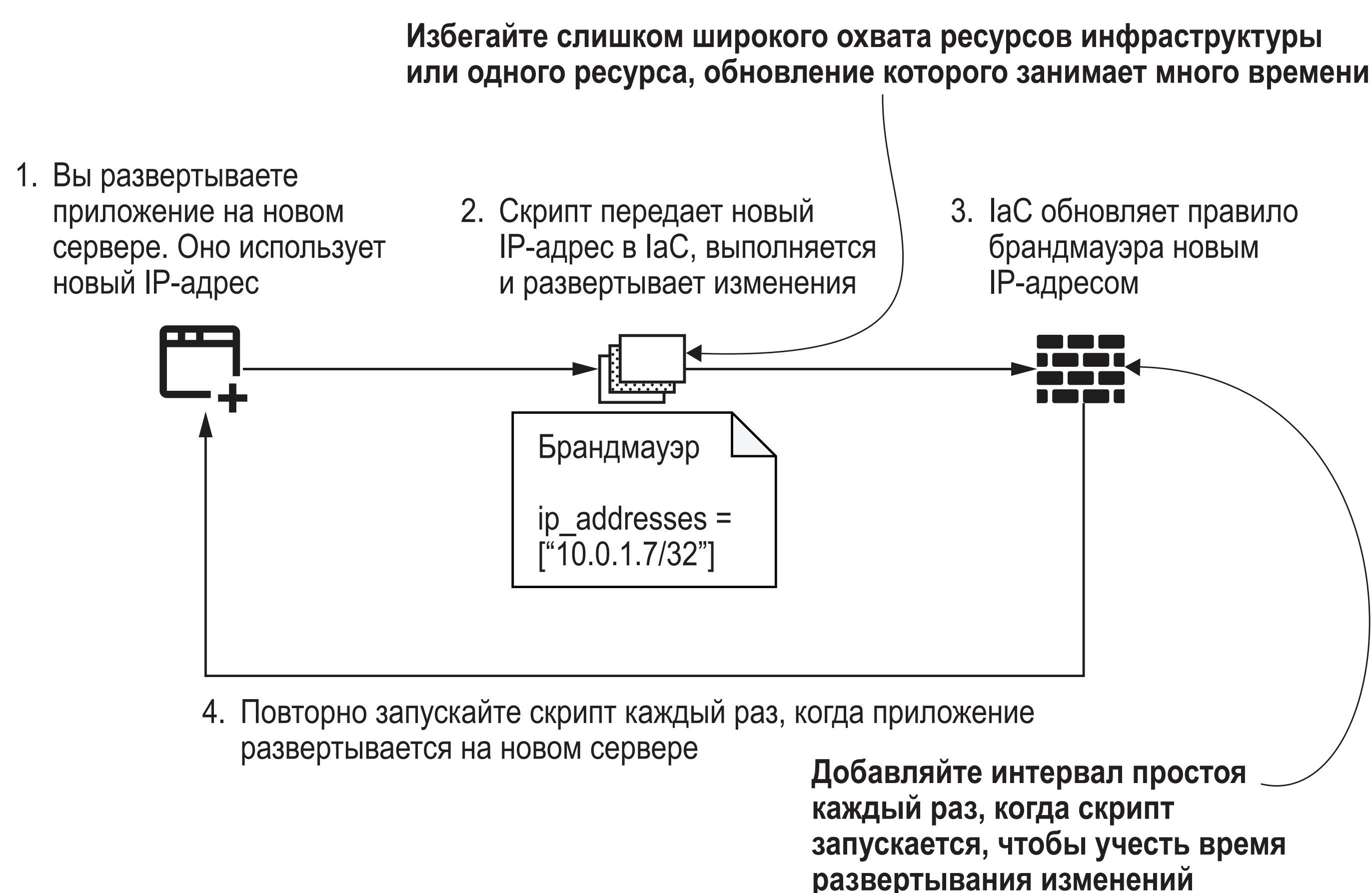
Рис. 13.14 Каждый раз, когда экземпляр приложения получает новый IP-адрес, модуль инфраструктуры обновляет правило брандмауэра, добавляя в него этот адрес
