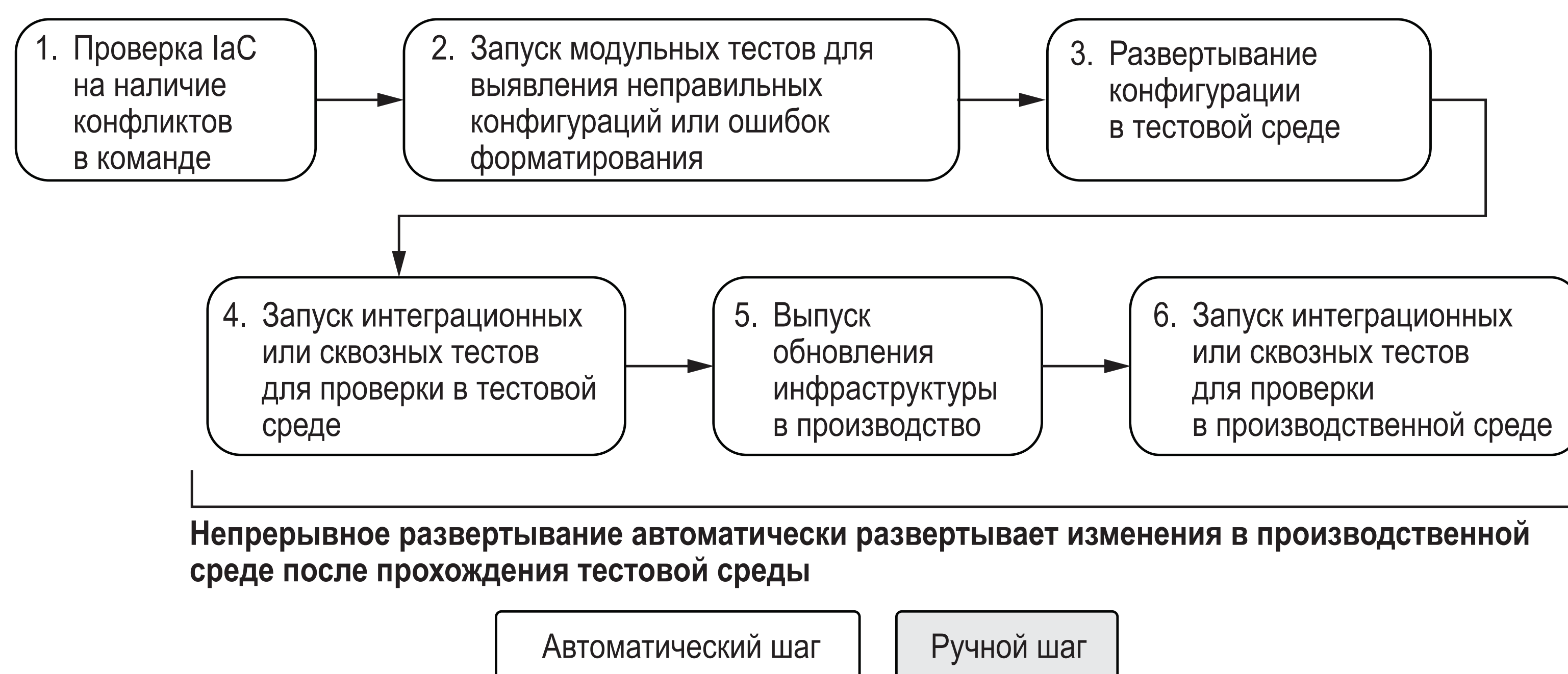
Рис. 7.6 Механизм непрерывного развертывания полностью автоматизирует тестирование и отправку изменений в производство
