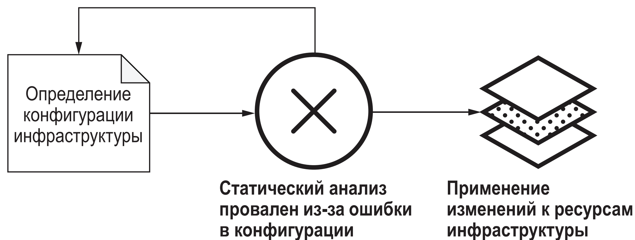
Рис. 6.3 Если статический анализ провален, мы можем либо исправить конфигурацию, чтобы пройти тест, либо вернуться к последней успешной конфигурации
