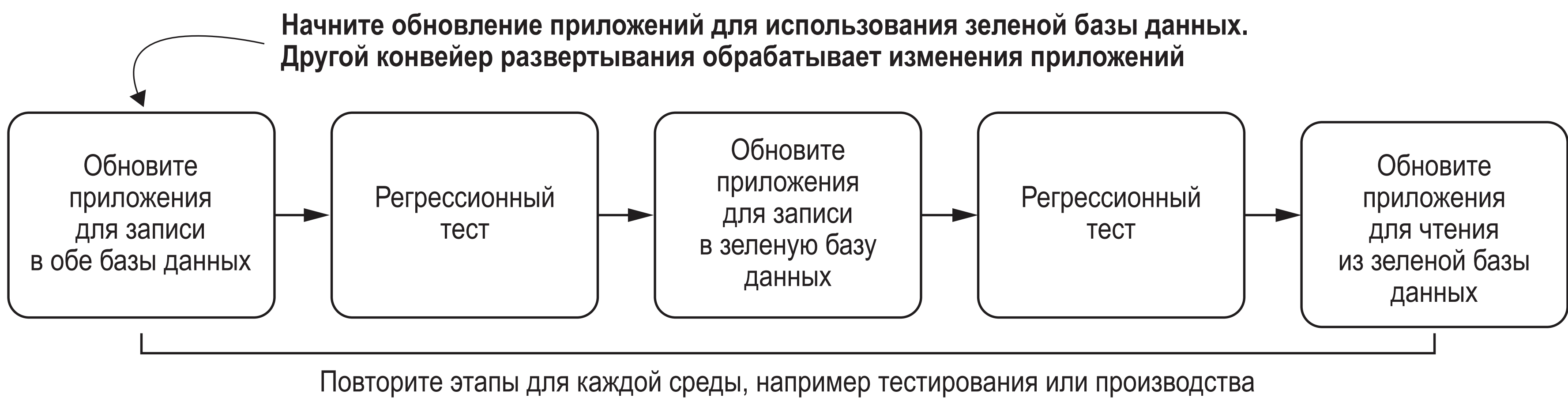
Рис. 9.12 Мы постепенно обновляем конвейер развертывания приложения для записи в обе базы данных, записи только в зеленую базу данных, а затем для чтения из зеленой базы
