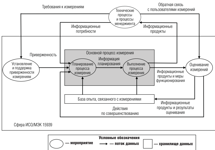
Рис. 52. Модель процесса измерения
