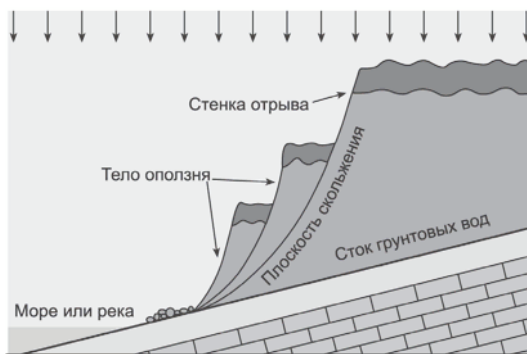
Рис. 77. Схема образования оползня
