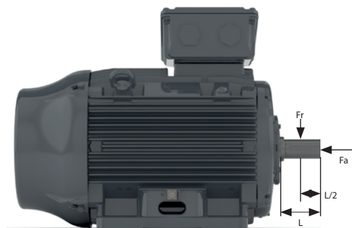
Рисунок 7 - Радиальная и осевая нагрузка на вал двигателя
