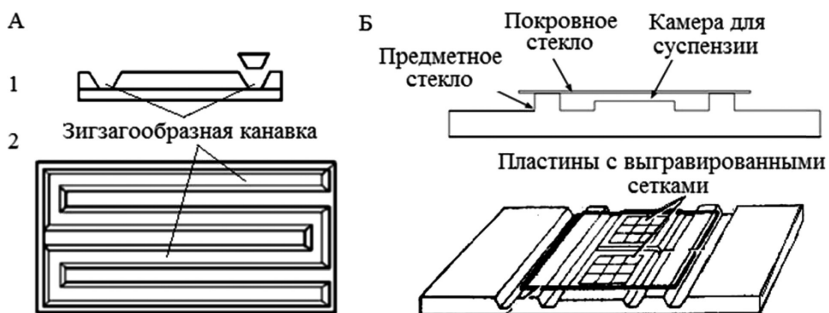
Рис. 127. Счетные камеры различных систем: А – Богорова; Б – Горяева и Фукса–Розенталя (1 – вид сбоку; 2 – вид сверху)
