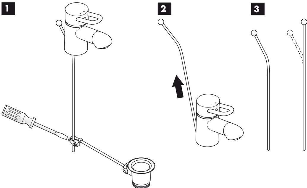
**DE** Neue Zugstange dem demontierten Muster anpassen.
