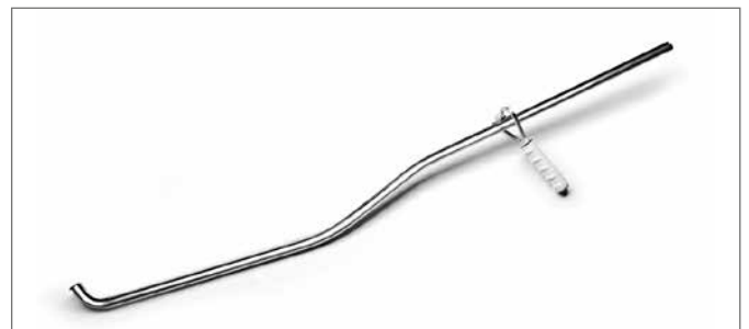
Рис. 21-57 Штанга для установки поворотных клипс QUATTRO
