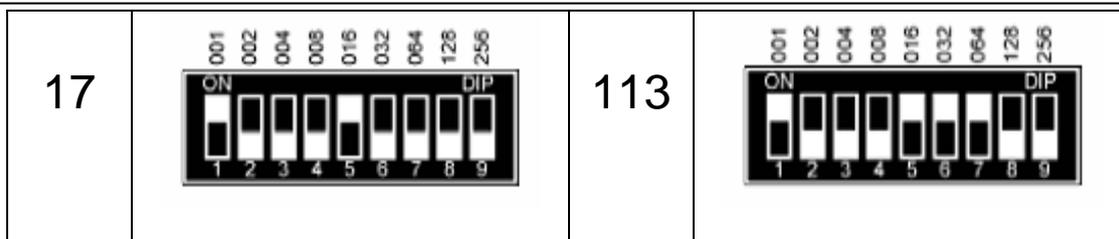
Der Laser hat 9 Betriebskanäle (internationaler Standard DMX 512 Signal). Es ist darauf zu achten, dass entsprechend 9 Kanäle hinter der Startadresse nicht für andere DMX-Geräte belegt werden dürfen. Die nächste mögliche Adresse eines DMX-Gerätes, welches hinter ein Gerät mit Startadresse 1 geschaltet ist, muss somit mindestens 10 sein.
