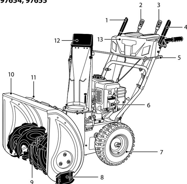
1. Рычаг включения привода на колеса
