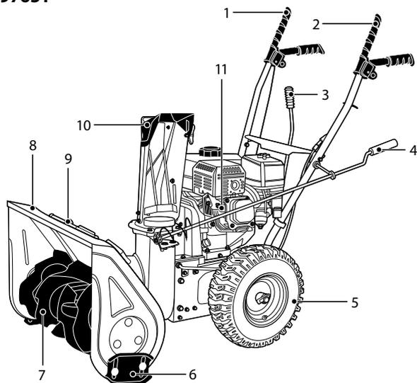
1. Рычаг включения привода на колеса
