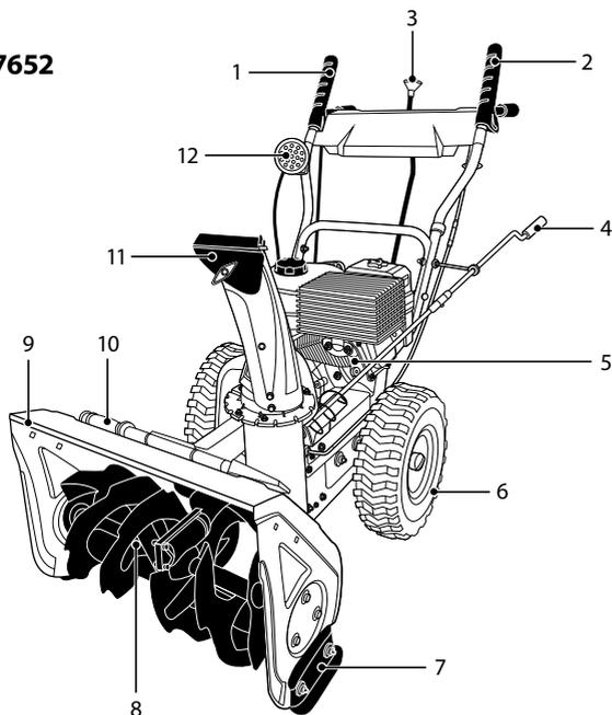
1. Рычаг включения привода на колеса
