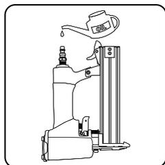
Подключите шланг подачи воздуха к входному штуцеру. Проверьте работоспособность инструмента, приведя его в действие: уберите палец с выключателя и поместите инструмент на рабочую поверхность. Нажав 2-3 раза на спусковую скобу, передвигайте его по поверхности. При этом шток должен перемещаться.
