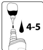
Для смазывания устройства применяйте масло для пневмоинструмента с вязкостью ISO-VG32 и автоматическую масляную воздушную магистраль, настроенную на подачу 2 капель в минуту. Если применение автоматической воздушной магистрали невозможно, то вводите 4-5 капель масла для пневматического инструмента в отверстие впускного
