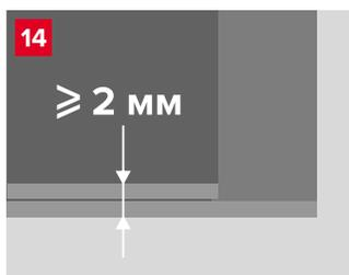
14 **ВАЖНО!** Толщина каждого нанесенного слоя не должна превышать 1,5 мм. Общая толщина гидроизоляции после высыхания мастики должна составлять не менее 2 мм.
