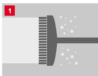
1 Очистите поверхность от пыли и грязи с помощью щетки или пылесоса.
