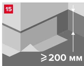
15 В местах примыкания горизонтальной поверхности к вертикальным (стенам, трубопроводам) и другим конструкциям, выступающим над горизонтальной поверхностью, гидроизоляция предусматривается непрерывной на высоту не менее 200 мм от уровня покрытия пола и требует дополнительного усиления армирующим материалом.
