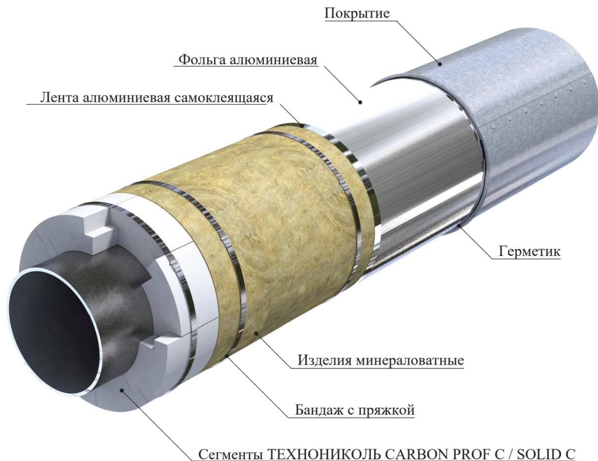
На магистральных трубопроводах тепловых сетей, нефтепроводов необходимо устройство противопожарных вставок из негорючих теплоизоляционных материалов, являющихся препятствием для распространения горения.
