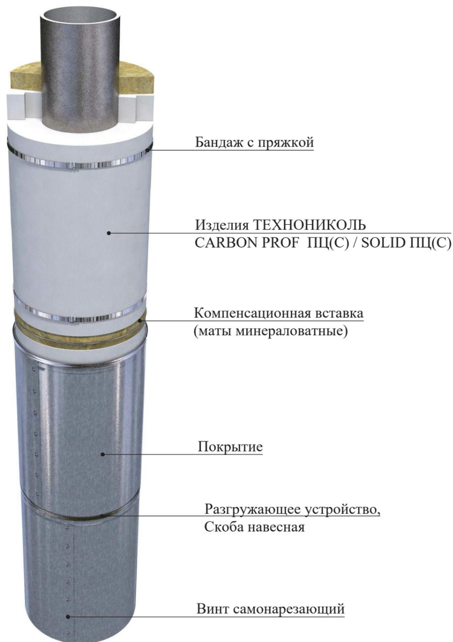
На вертикальных трубопроводах предусматриваются разгружающие устройства, состоящие из разгружающих колец с ребрами, которые изготавливаются из лент или полос из углеродистой или нержавеющей стали (в зависимости от материала трубопроводов) шириной 30 мм, толщиной 2 - 3 мм.
