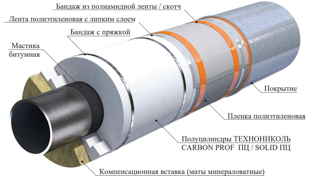
Теплоизоляционные полуцилиндры ТЕХНОНИКОЛЬ CARBON PROF / SOLID применяются в конструкциях изоляции трубопроводов наружным диаметром от 57 до 108 мм.
