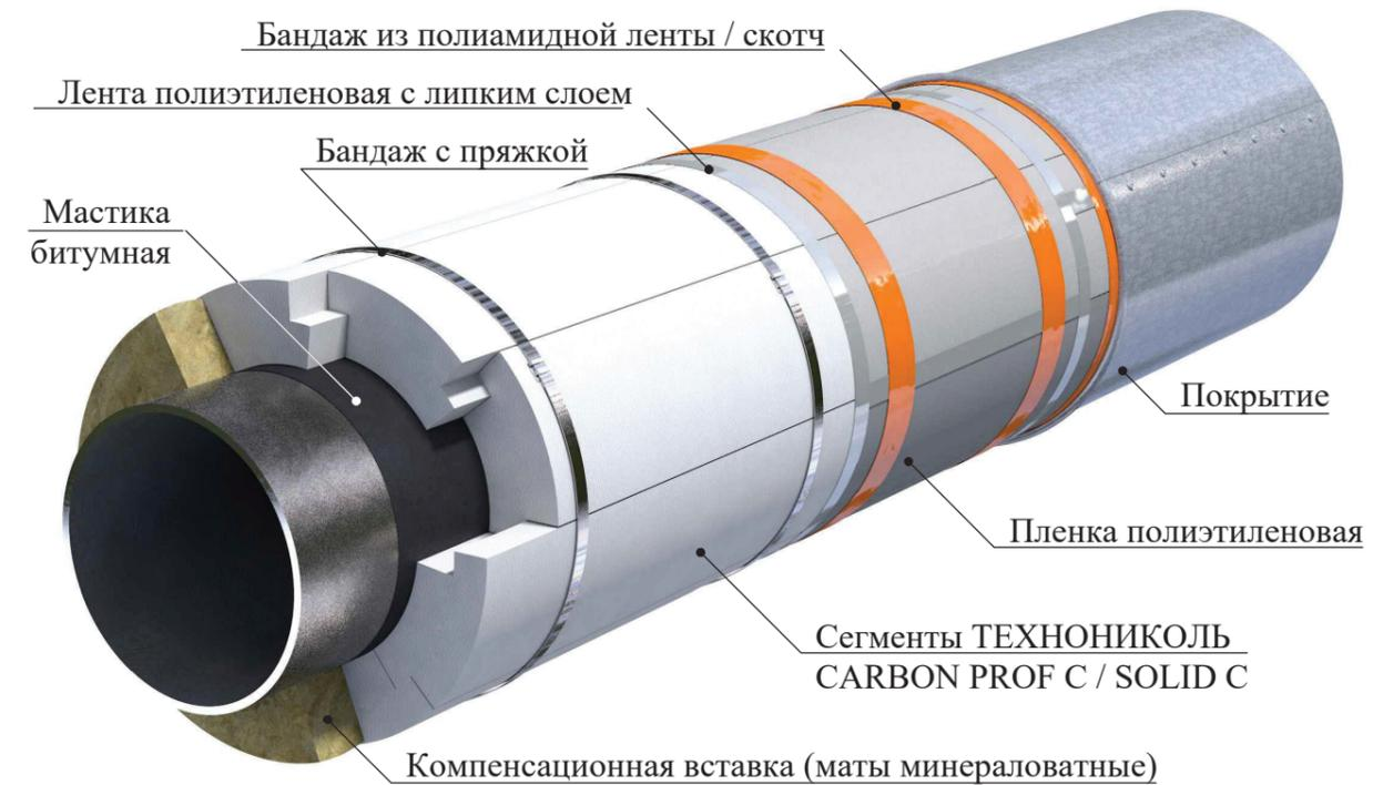
Теплоизоляционные сегменты ТЕХНОКОЛЬ CARBON PROF / SOLID применяются в конструкциях изоляции трубопроводов наружным диаметром от 133 до 1420 мм.
