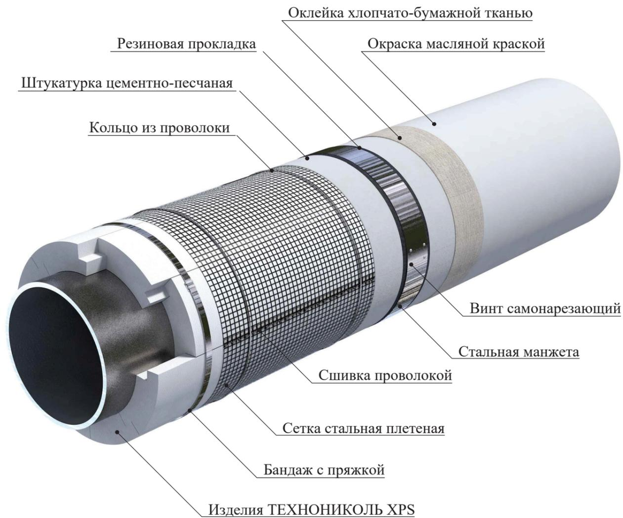
Штукатурное покрытие выполняется по армирующей металлической сетке. Для армирования применяют сетку стальную плетеную с ромбической ячейкой 12x1,2, 12x1,4.
