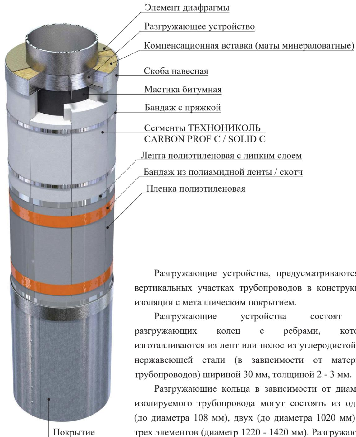
Разгружающие устройства, предусматриваются на вертикальных участках трубопроводов в конструкциях изоляции с металлическим покрытием.
