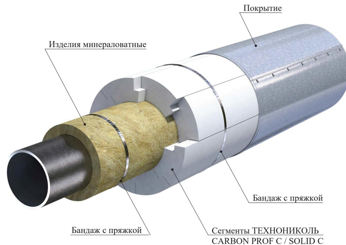
В двухслойных конструкциях тепловой изоляции трубопроводов с температурой от 76 до 115°С для крепления промежуточного слоя из волокнистых материалов могут применяться бандажи из ленты стальной упаковочной или проволочные кольца. Элементы крепления устанавливаются с шагом 500 мм по длине трубопровода.
