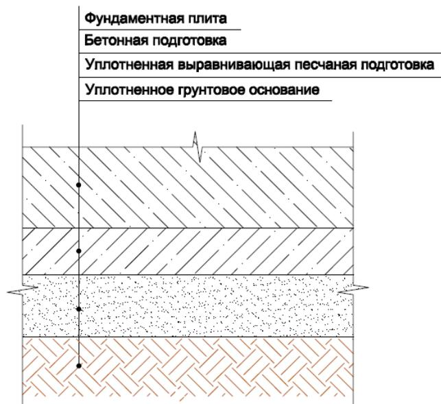
Рисунок 1 – Конструкция фундамента с подготовкой из бетона
