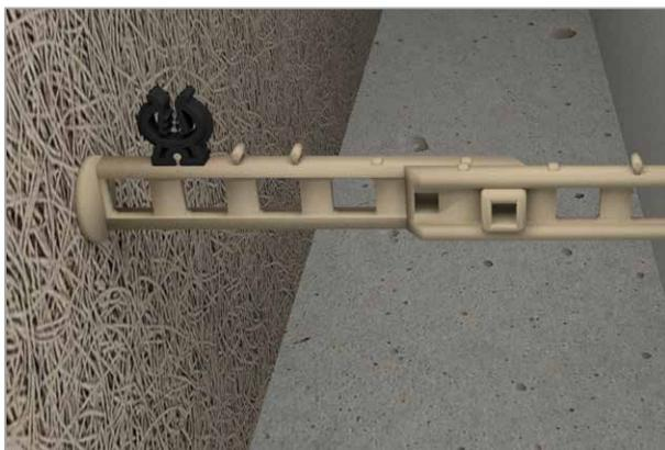
Далее нужно скрепить обе стяжки, совместив замки ответных частей (при необходимости можно использовать удлинитель для модульного элемента стяжки).
