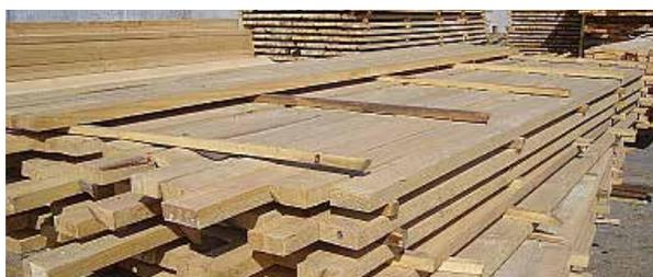
**Доска обрезная** 40 (50) x 100 мм для устройства упоров несъемной опалубки.
