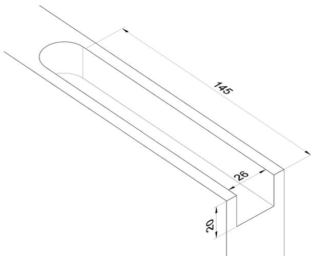
Для установки врезного держателя в полотне необходимо отфрезеровать паз 145x26x20 мм с двух сторон полотна. Допускается фрезеровка паза во всю ширину полотна.
