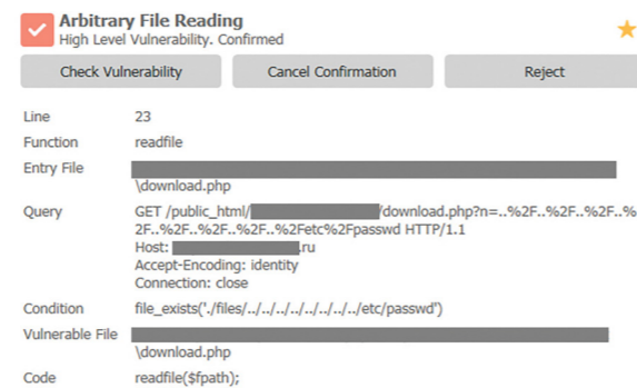
Рис. 12. Пример обнаружения уязвимости «Чтение произвольных файлов»
