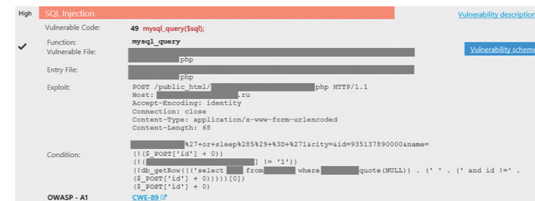
Рис. 14. Пример обнаружения уязвимости «Внедрение операторов SQL»
