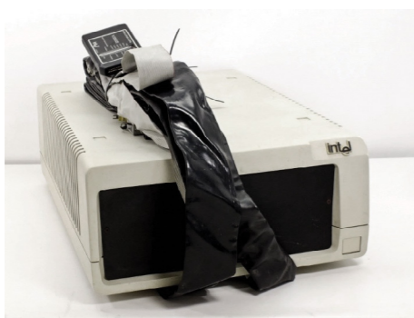
Рис. 1. Intel I2ICE — один из первых внутрисхемных отладчиков для процессоров Intel 80386 (recycledgoods.com/intel-series-iv-emul-system-iii514b.html)
