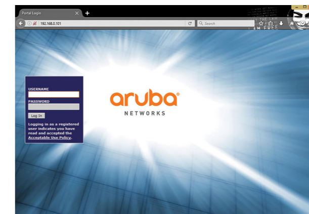
Рис. 12. Форма аутентификации поддельной точки доступа
