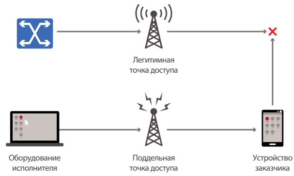
Рис. 2. Атака с применением поддельной точки доступа
