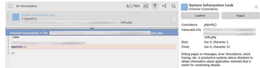
Выявленная уязвимость «Утечка отладочной информации»
