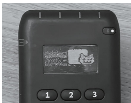
Рисунок 21. Ролик Nyan Cat на дисплее терминала Miura M010. Удаленное выполнение кода открывает злоумышленнику полный доступ к операционной системе терминала
