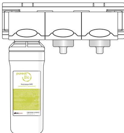
Рис. 1 Установка картриджа «Clean Filter» в установки серий PPA и PPU
