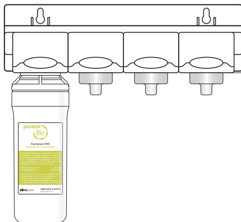
Рис. 2 Установка картриджа «Clean Filter» в установки PPR-1140 и Акватон
