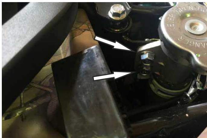
Открутите патрубков заливной горловины
