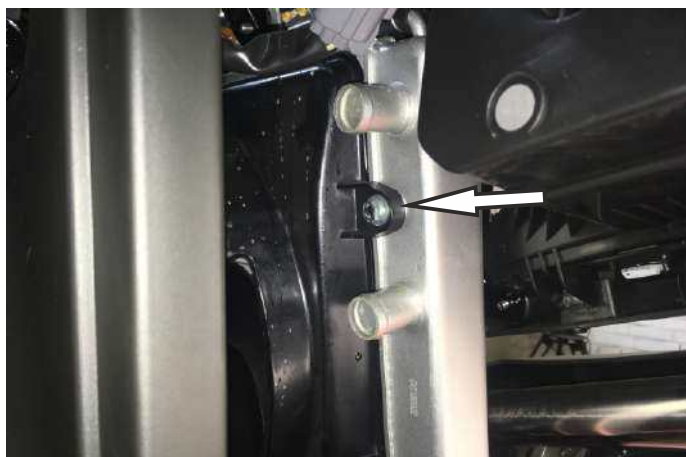
Открутите винты крепления вентилятора радиатора
