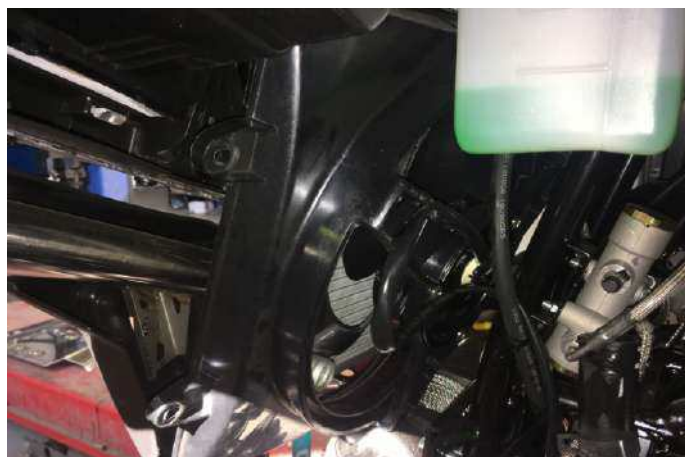
Снимите вентилятор радиатор с левой стороны
