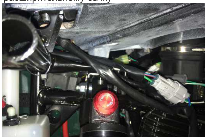
Подключите клемму вентилятора радиатора
