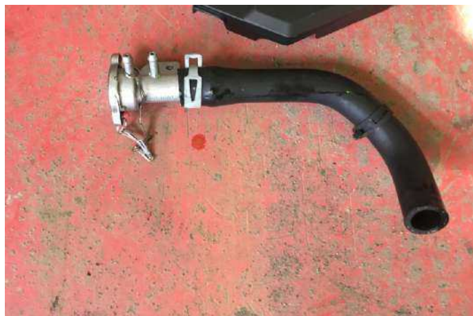
Снимите патрубок заливной горловины
