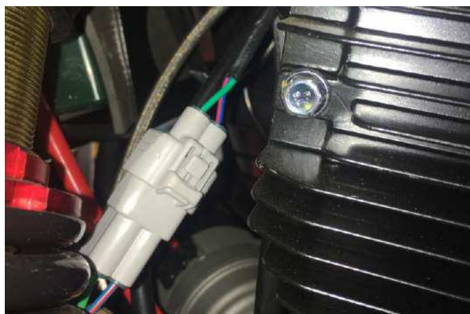
Отсоедините клемму вентилятора радиатора
