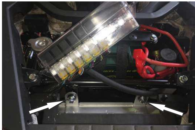
Открутите верхние болты крепления радиатора
