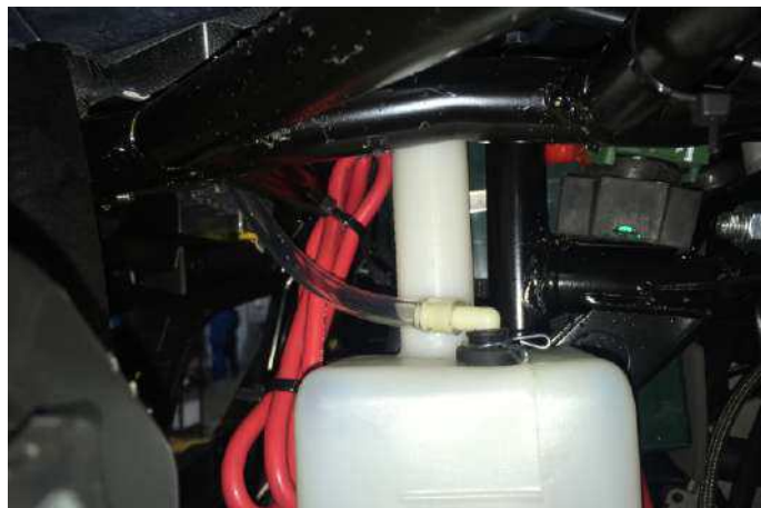
Подключить возвратный шланг к расширительному баку
