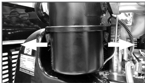
Рис. 16 Снятие стакана воздухоочистителя
