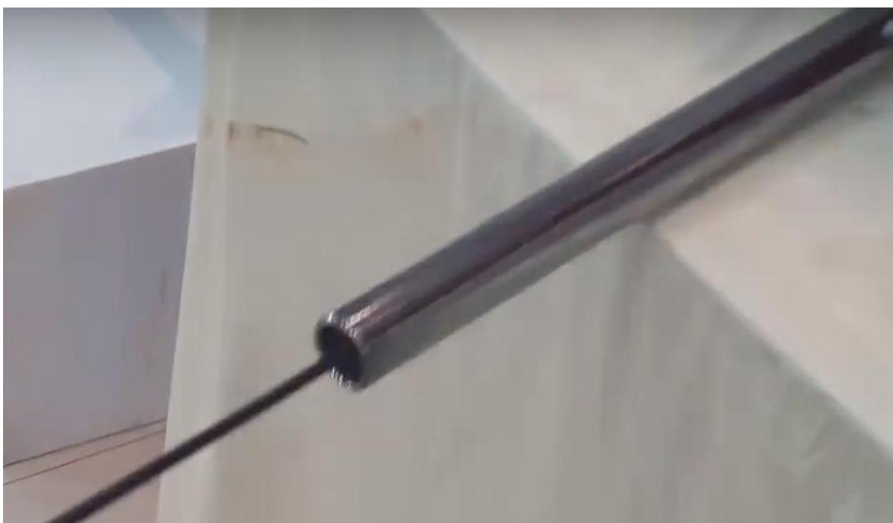
26. Подсоедините трос газа к рукоятке, затем соедините его с базой двигателя
