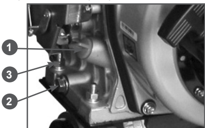
Рис. 10 Проверка уровня масла в картере
