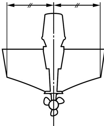
**Рис. 6 Установка мотора на линии киля лодки**
