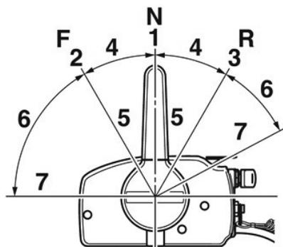
**Рис. 21 Положения рычага управления
