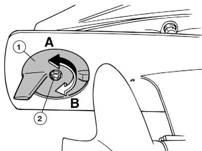
**Рис. 40 Регулировка триммера**
