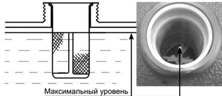
Рис. 20 Максимальный уровень топлива во внешнем баке
