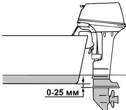
**Рис. 5 Установка подвесного лодочного мотора на транец лодки**
