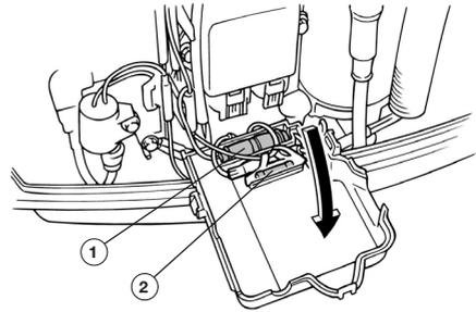
**Рис. 42 Замена предохранителя**
