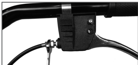
Рис. 10 Установка регулировочной муфты троса газа
