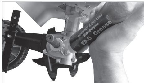
Рис. 24 Добавление смазки в корпус редуктора
