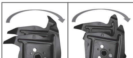
Рис. 3 Маркировка и направление вращения фрез
