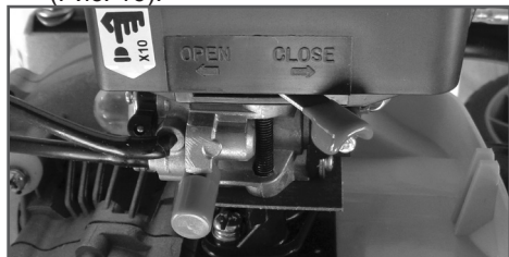
Рис. 16 Воздушная заслонка карбюратора закрыта
