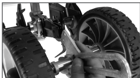
Рис. 6 Установка кронштейна колес
