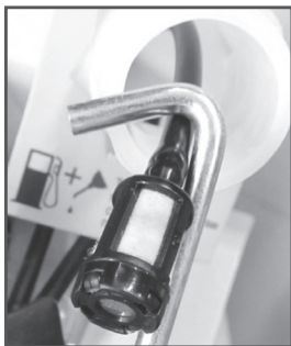
Рис. 21 Извлечение топливного фильтра
