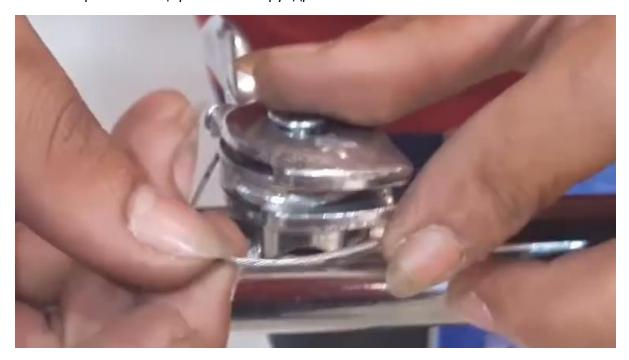
Закрепите конец троса газа с помощью бокового болта на дроссельной заслонке:
