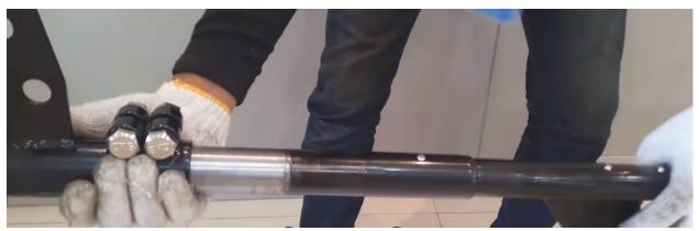
Примечание: Проверьте короткий вал на предмет осевого люфта. Подергайте вал вперед-назад. Если вас сел плотно – осевого люфта быть не должно! Если люфт есть, вероятнее всего, короткий вал не до конца сел на вал отбора мощности болотохода. Необходимо, чтобы шлицы вала отбора мощности и короткого вала соединились, а вал до упора был вставлен в кожух.
