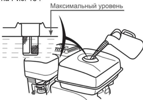
Рис. 13 Максимальный уровень топлива в топливном баке
