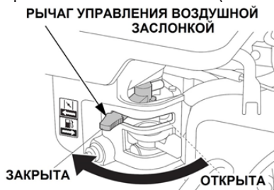
Рис. 15 Рычаг управления воздушной заслонкой (вид сверху)
