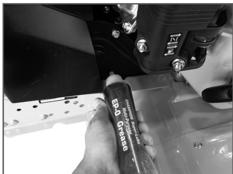
Рис. 26 Добавление смазки в редуктор
