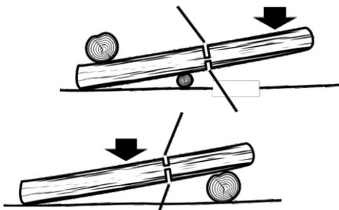
Во избежание защемления пильной шины и цепи внимательно следите за механическим напряжением бревна.
