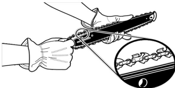
Установите крышку шины, проверяя чтобы цепь не выпала из паза шины, следите за тем чтобы установленная под крышку скоба натяжителя была ориентирована зубцами согласно рисунку, чтобы штифт натяжителя цепи не вышел из соответствующего отверстия на шине, далее наживите и закрутите, не затягивая туго, гайку крышки шины.
