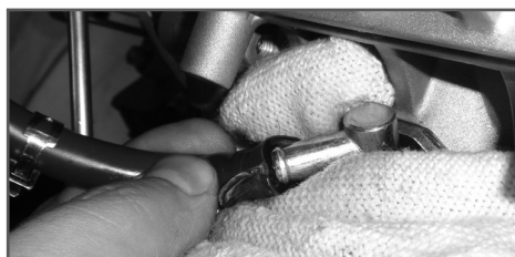
Рис. 10 Удаление воздуха из топливного шланга
