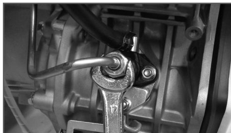
Рис. 12 Удаление воздуха из топливного насоса
