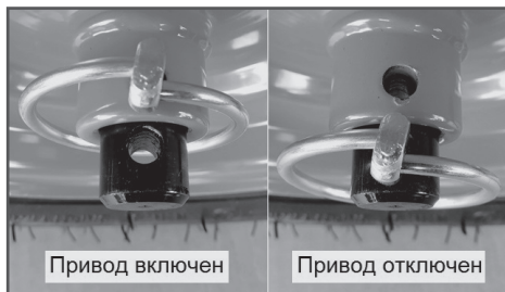
Рис.10 Перестановка шплинта на левом колесе
