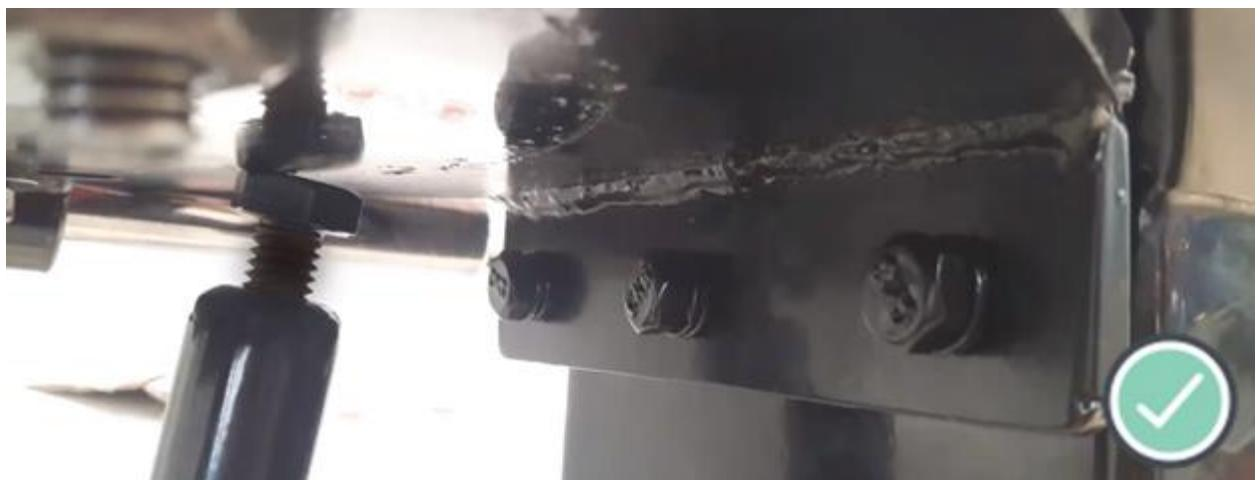
**17. Установите и затяните болт крепления звездочки на валу**
