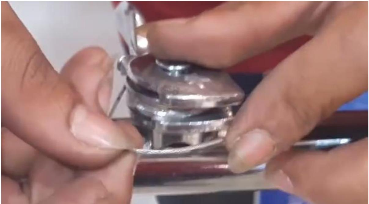
Закрепите конец троса газа с помощью бокового болта на дроссельной заслонке:
