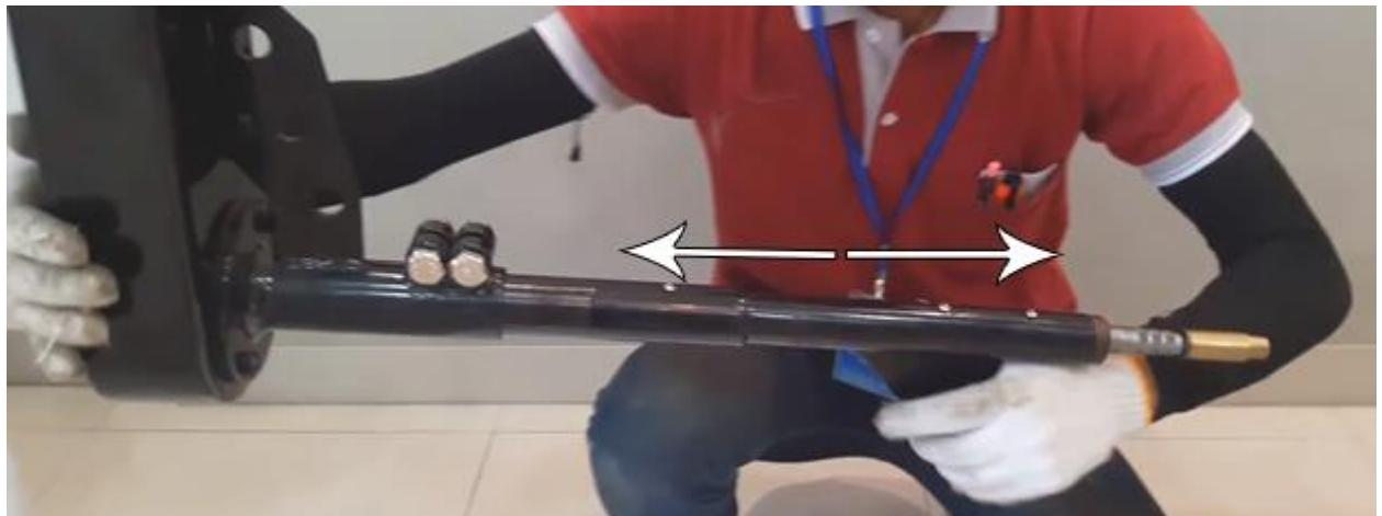
**Примечание:** ввиду расширения материалов при нагревании, производителем допущен поперечный (влево-вправо / вверх-вниз) люфт для предотвращения износа.
