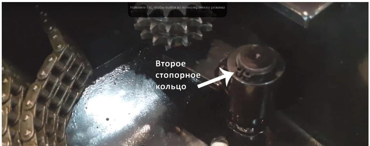
**10. Установите уплотнительную втулку на вал двигателя**
