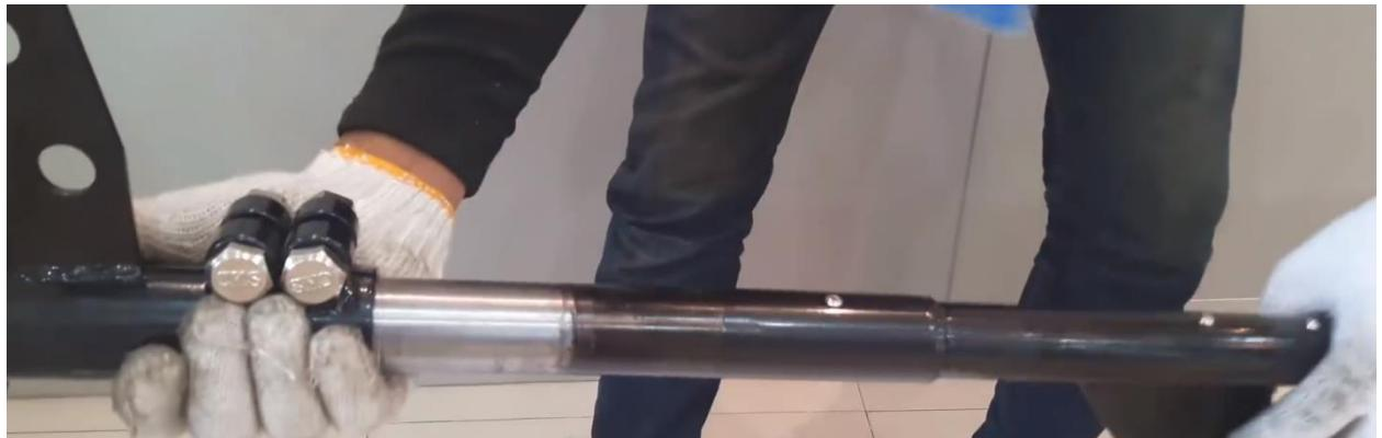
**Примечание:** Проверьте короткий вал на предмет осевого люфта. Подергайте вал вперед-назад. Если вас сел плотно – **осевого люфта быть не должно!** Если люфт есть, вероятнее всего, короткий вал не до конца сел на вал отбора мощности болотохода. Необходимо, чтобы шлицы вала отбора мощности и короткого вала соединились, а вал до упора был вставлен в кожух.
