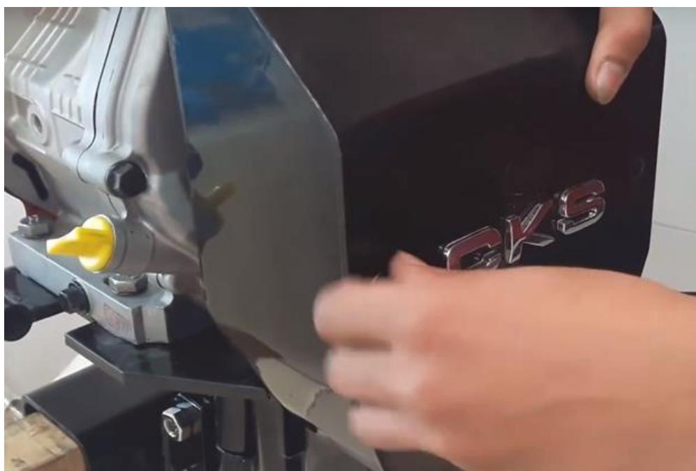
На свое усмотрение можете так же смазать стыки корпуса силиконовым гелем и герметиком.
